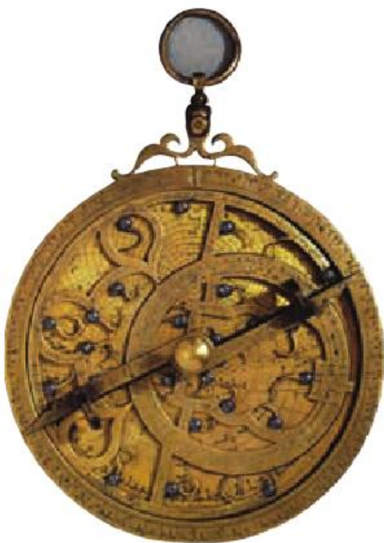
Astrolabio, instrumento empleado por los antiguos navegantes para orientarse.
